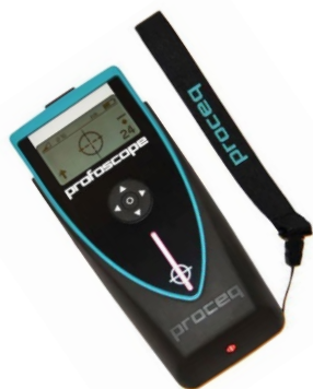
Figur 134 Uppmätning av täckskikt på en spännarmerad betongkonstruktion
