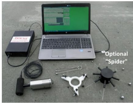
(a) (b) Figur 139 DOCTer Impact Echo: a) Utrustning. och (b) arbetsprincip
