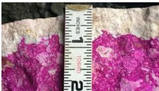
Figur 9 Applicering av fenoftalin på en nylig frilagd betongyta, ofärgat område är karbonatiserat ( www.structuralguide.com )
