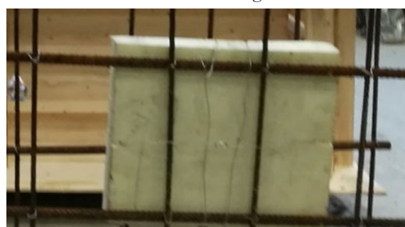
Ingjuten defekt för att simulera delaminering
