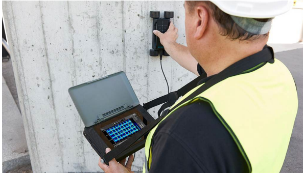
Figur 36 Användning av täckningsmätare, från ( http://www.proceq.com )
