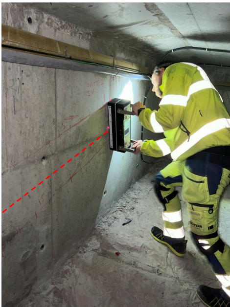
Figur 138 Skanning längs foderrör – följ utsatt linje, skanning var 10 cm
